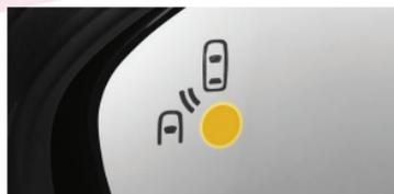
Le système de surveillance d'angle mort indique, par un pictogramme dans les rétroviseurs, la présence d'un véhicule dans les angles morts.
