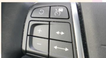
Ce dispositif agit automatiquement (sans action sur les commandes) et permet au véhicule d'en suivre un autre à une distance appropriée.
