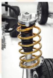
La suspension maintient le contact entre les roues et le sol malgré ses irrégularités (indispensable à la tenue de route). Elle réduit la fatigue mécanique et l'usure excessive. Elle améliore le confort des passagers.
